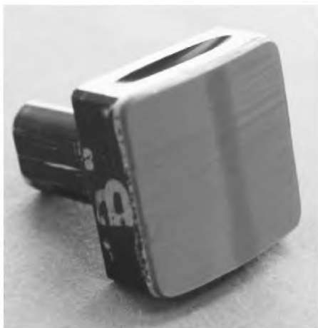
Рисунок 32 — Внешний вид датчика SBR с линией износа
