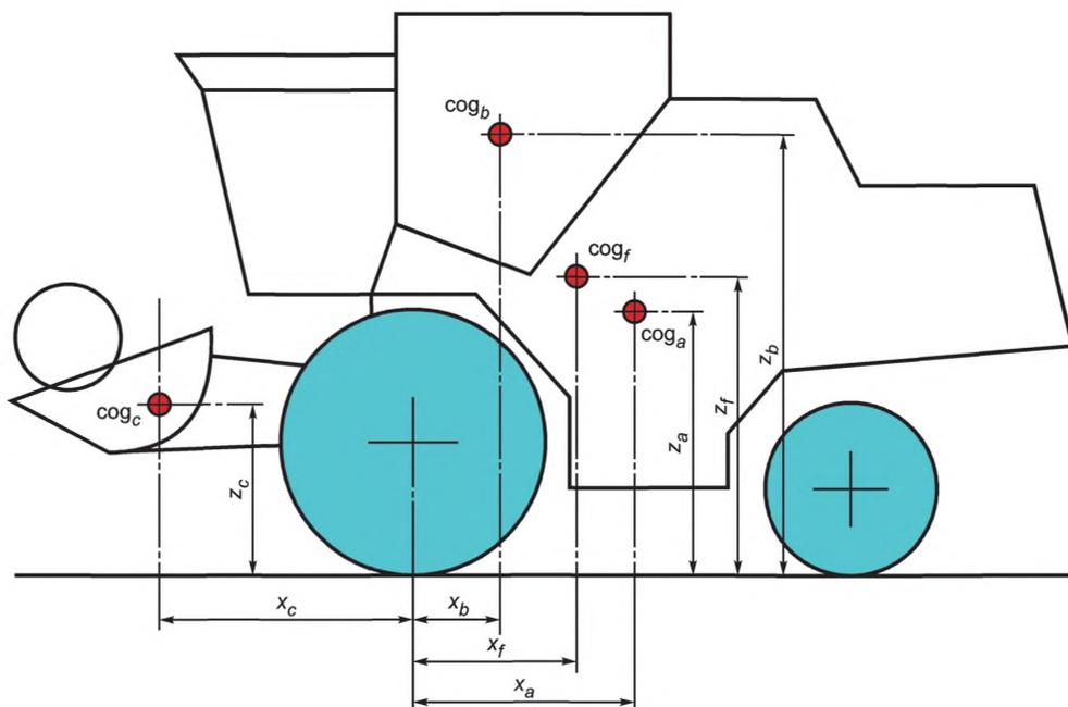
Рисунок 5 — Общий центр тяжести, определенный расчетным путем
