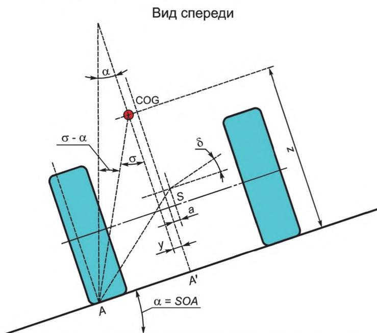
Рисунок 8 — Смещение центра тяжести при опрокидывании вокруг линии AS (двухмерное отображение)
