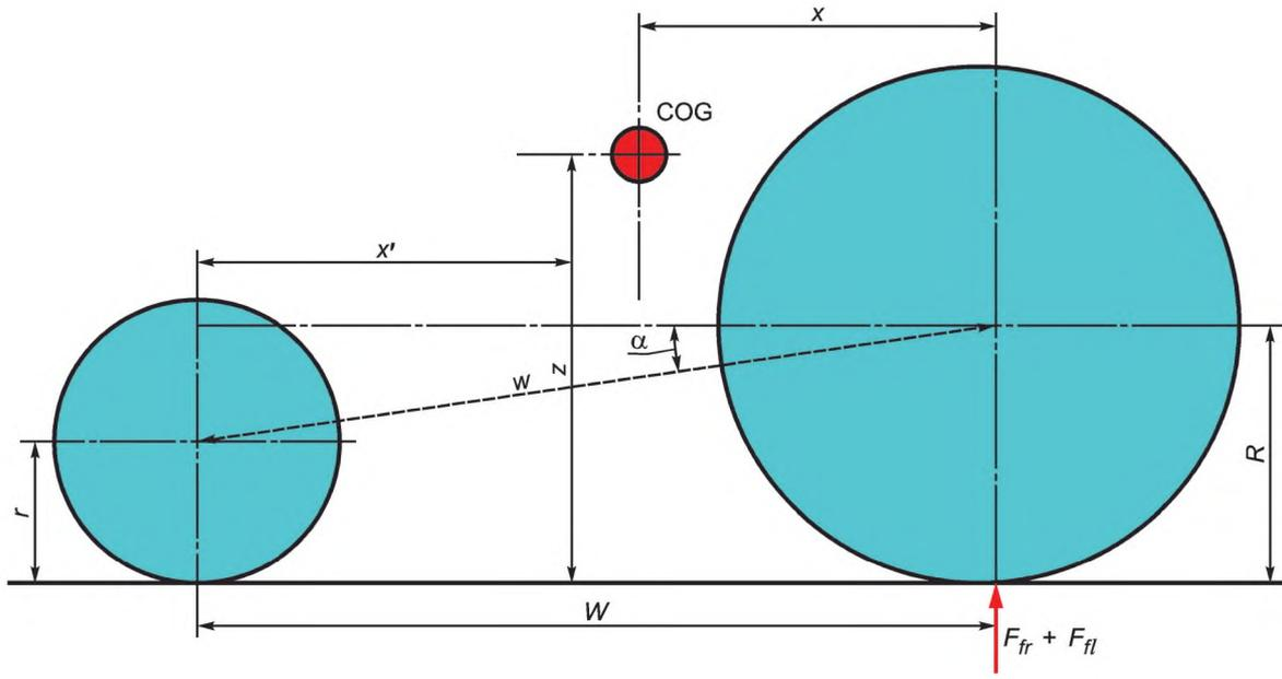
Рисунок 2 — Машина в горизонтальном положении (вид сбоку)
