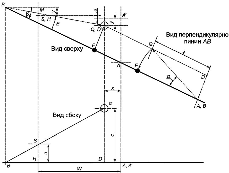
Рисунок 7 — Графическое определение угла статического опрокидывания  $SOA$
