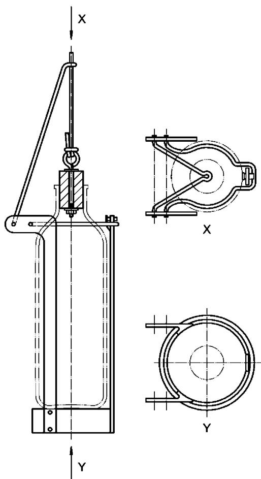
Рисунок В.2 — Утяжеленный каркас для ёмкости для отбора проб
