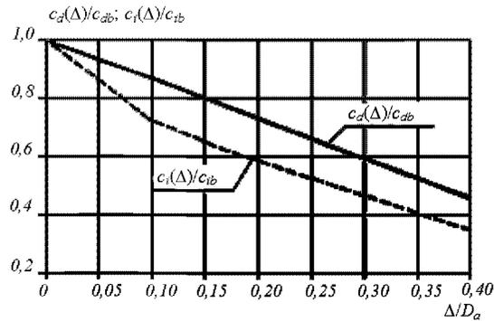
Рис. 3 Коэффициенты  $c_a$  и  $c_i$  в зависимости от относительного заглубления трубопровода  $\Delta/D_o$
