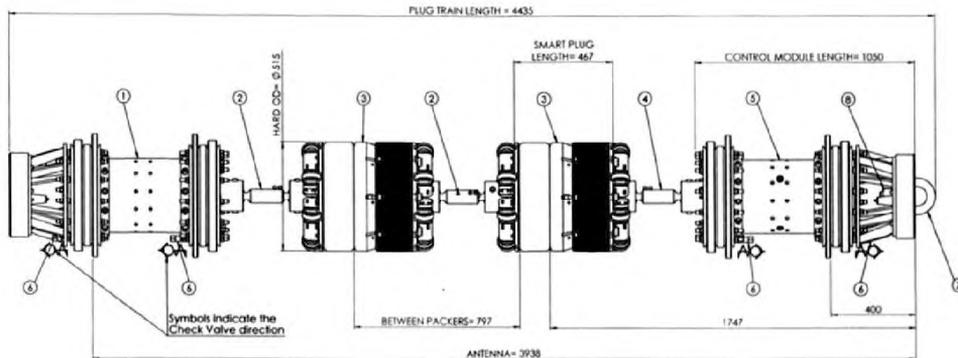
Рис. 12.3-4 Общий вид и компоновка затвора 2 × 24" типа SmartPlug:
