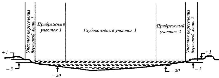
Рис. 10.1-1 Участки трассы морского трубопровода [3]
