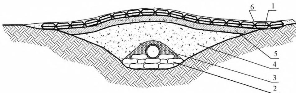
Рис. 12.1-2 Схема ремонта размыта с использованием гибких бетонных матов:
