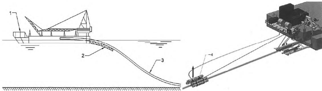
Рис. 7.1-1 Схема *S*-метода укладки морского подводного трубопровода:
