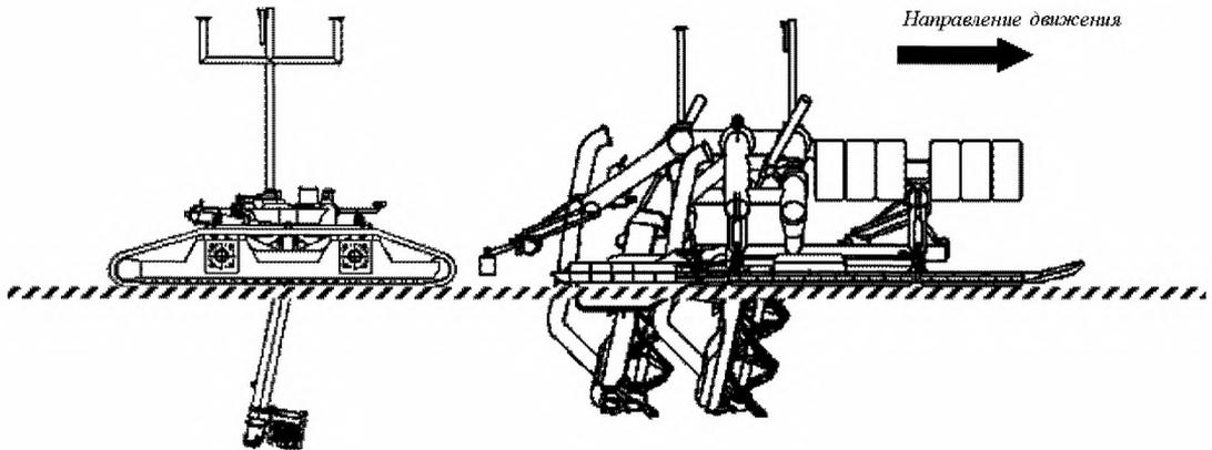
Рис. 7.6-2 Устройство заглабления подводного трубопровода компании Saipem S.p.A.
