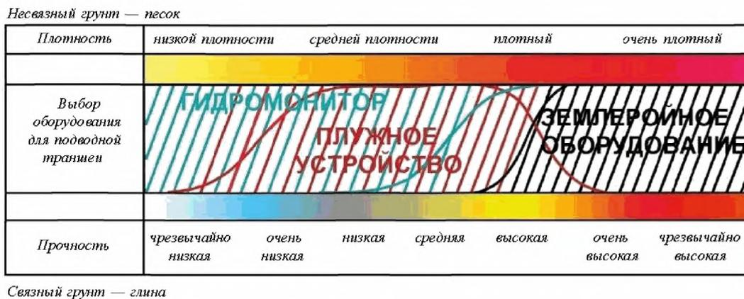
Рис. 10.2-3 Выбор технологии подготовки подводной траншеи [1]
