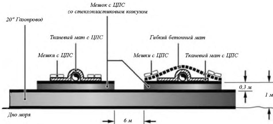
Рис. 11.2-2 Примеры конструктивных решений по пересечениям подводных трубопроводов [2]
