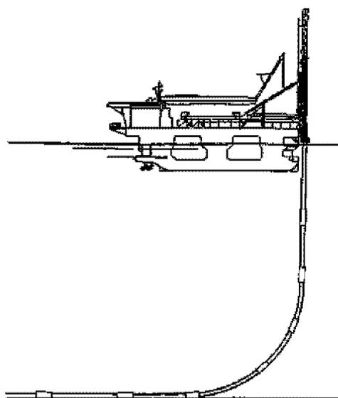
Рис. 7.1-2 Схема *J*-метода укладки морского подводного трубопровода [1]
