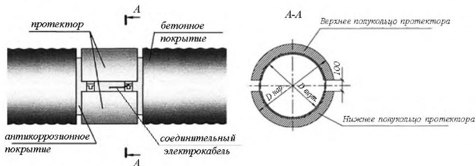
Рис. 8.4-1 Схема установки протектора на обетонированный трубопровод
