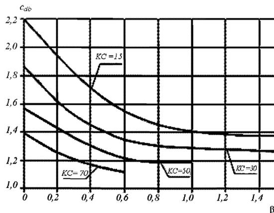
Рис. 9-1 Коэффициент  $c_{db}$  в зависимости от коэффициента  $\beta$
