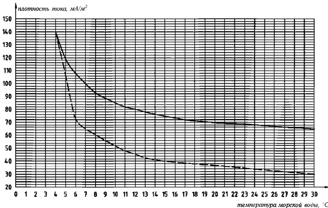
Рис. 8.4-3 Зависимость средней плотности тока от температуры воды
