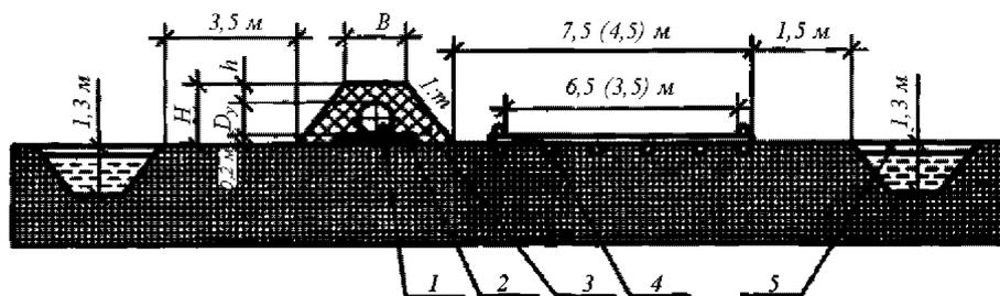
Рис. 11.2-4 Схема прокладки трубопровода по поверхности обводненного грунта или болотистой местности:
