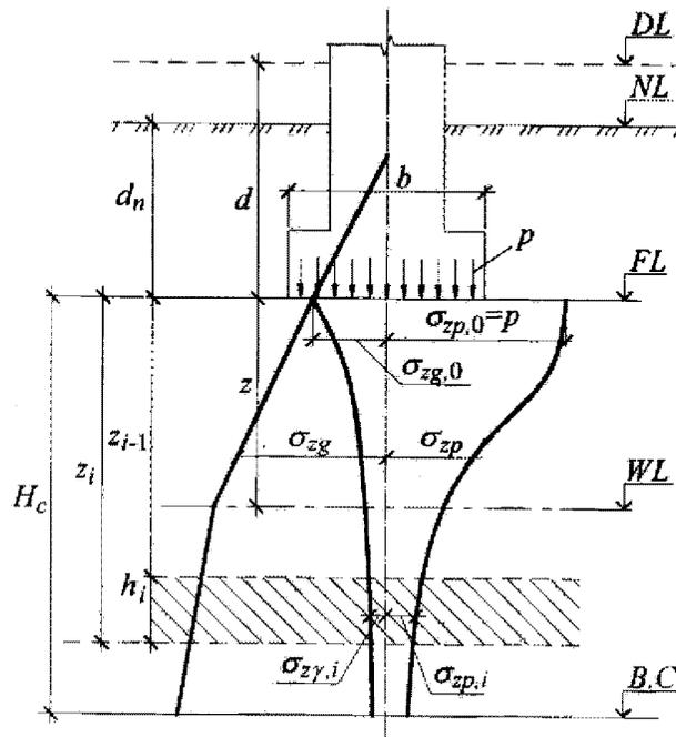
Рис. 3.3.7 Схема распределения вертикальных напряжений в линейно-деформируемом полупространстве
