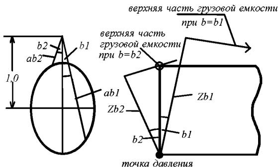
Рис. 23.1.4 Схема для определения разницы динамического давления
