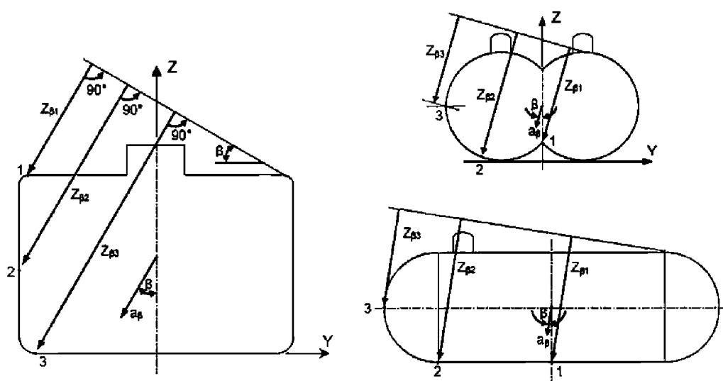
Рис. 28.1.2-3 Определение высоты жидкости  $Z_\beta$  для точек 1, 2 и 3
