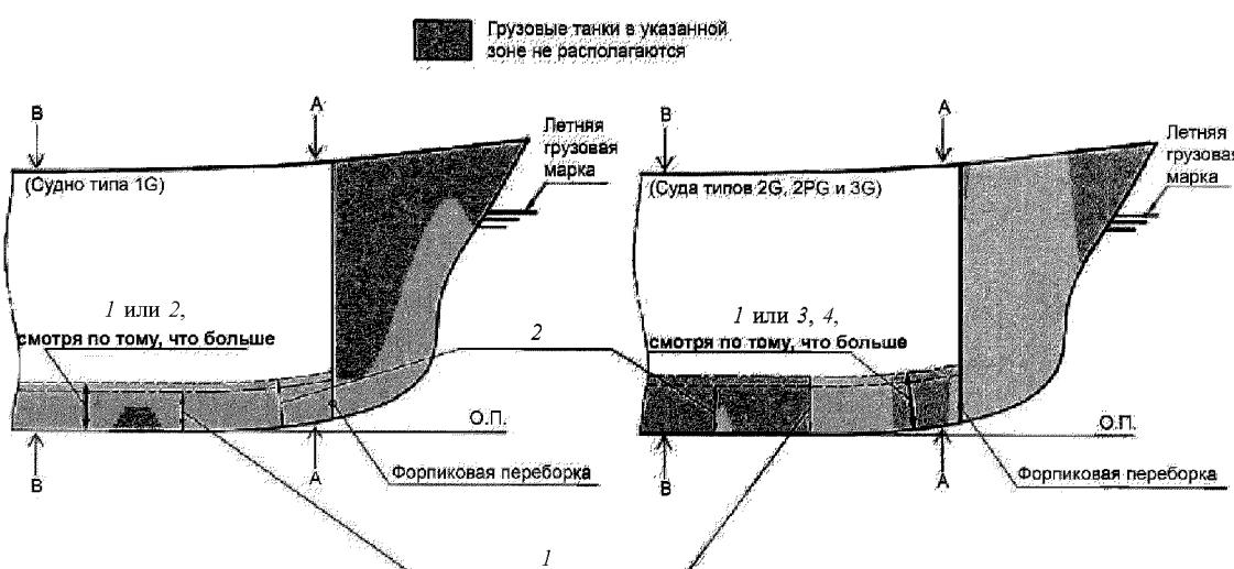
Вид в диаметральной плоскости – суда типов 1G, 2G, 2PG и 3G
