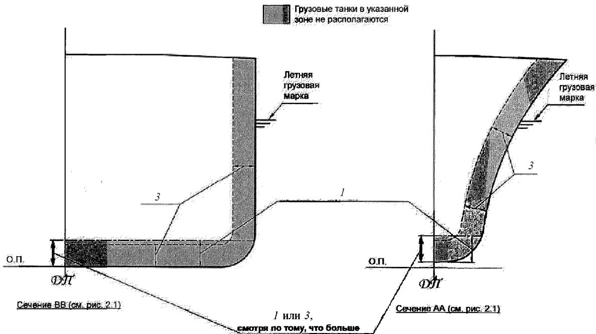
Поперечные сечения – суда типов 2G и 2PG
