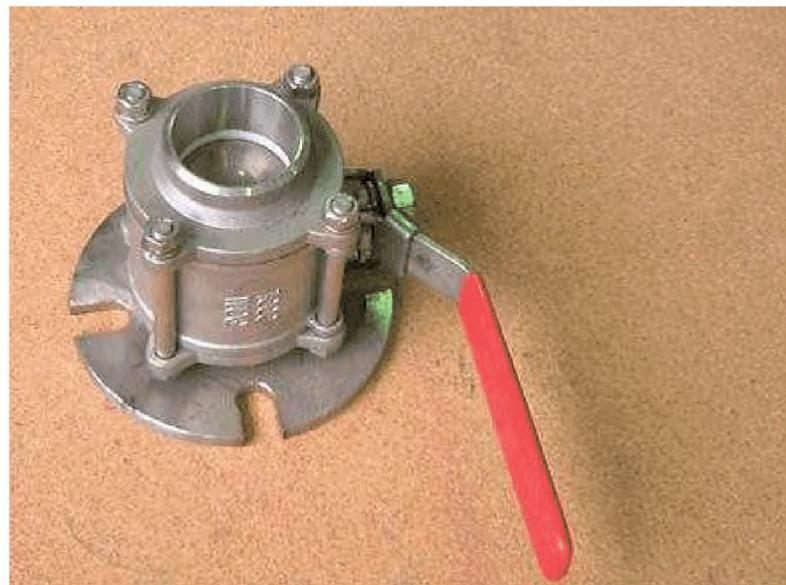
Рис. 11.5-3 Типичный шаровой клапан
