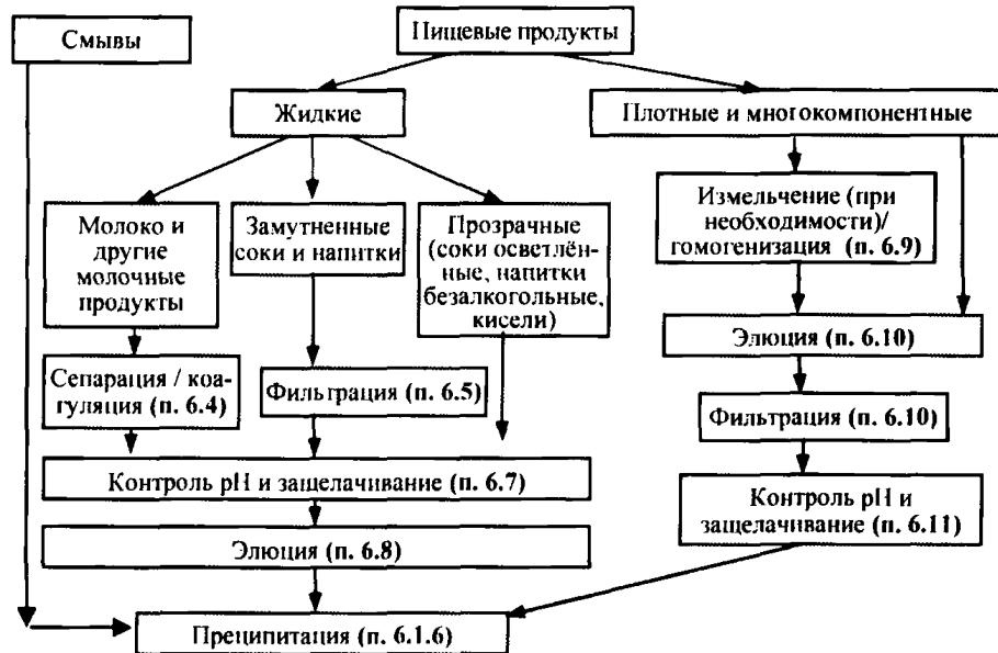
Рис. 1. Алгоритм получения вируссодержащих водных концентратов из образцов пищевых продуктов и смылов для исследований с применением МАНК
