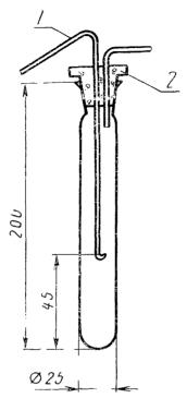
I—трубка из нержавеющей стали по ГОСТ 5632—72 диаметром 3: 2—фторопласт».
