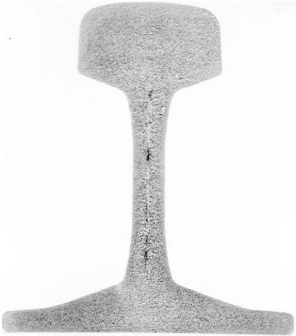
Рисунок И.2 — Незначительная прямая и обратная ликвация (серный отпечаток)
