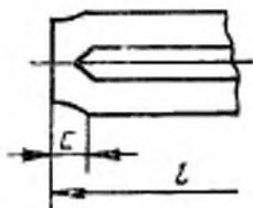
1) Угол  $70^\circ$  применяется только на штифтах, изготовленных из стали, указанной в таблице 2. Угол насечки может изменяться в зависимости от пластичности материала
