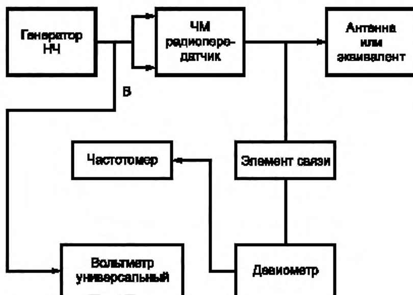
Рисунок 1 — Схема измерений параметров систем стереофонического радиовещания
