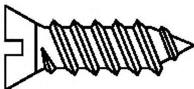
Рисунок 1 — Самонарезающий формующий винт
