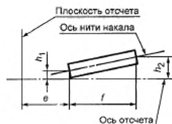
Рисунок 5 — Допустимое смещение оси нити накала 9 (только для эталонных ламп накаливания)
