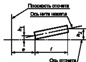
Рисунок 6 — Допустимое смещение оси нити накала (только для эталонных ламп накаливания) 1)
