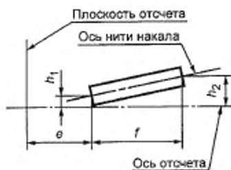
Рисунок 5 — Смещение нити накала 37 (только для эталонных ламп накаливания)
