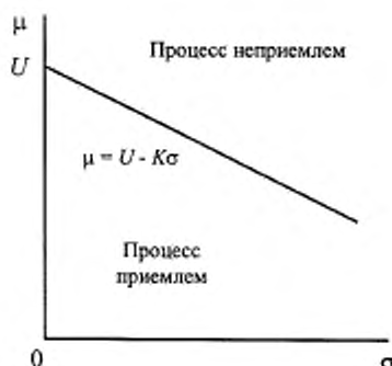
Рисунок 9 — Приемочная карта для верхнего предела поля допуска ( \sigma и \mu известны)
