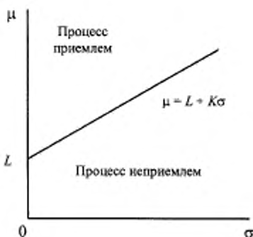
Рисунок 8 — Приемочная карта для нижнего предела поля допуска ( \sigma и \mu известны)
