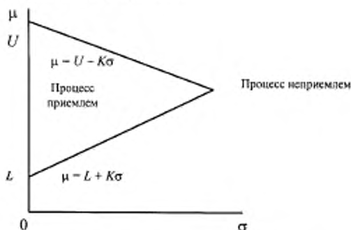
Рисунок 10 — Приемочная карта для двустороннего допуска ( \sigma и \mu известны)
