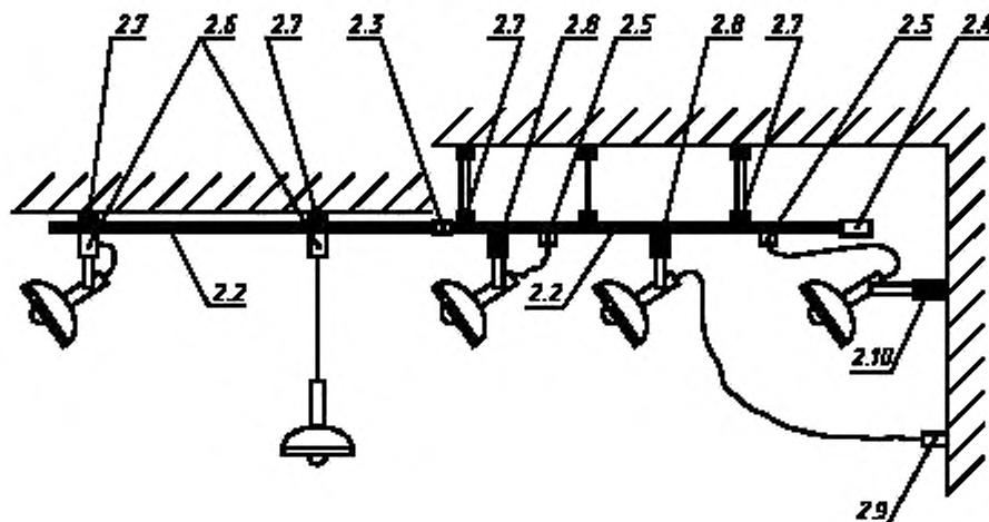
2.2 — секция шинопровода; 2.3 — соединитель; 2.4 — входное устройство (может включать трансформатор); 2.5 — штепсель (питание только от секции шинопровода); 2.6 — адаптер для механического и электрического присоединения светильника к шинопроводу; 2.7 — подвес шинопровода (к потолку, к подвеске из труб или проволоки); 2.8 — подвес светильника; 2.9 — независимая коробка с розеткой; 2.10 — механическое закрепление светильника к стене;
