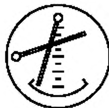
Рисунок 9 — Индикатор самолета, указывающий отклонение от горизонтального и вертикального курса
