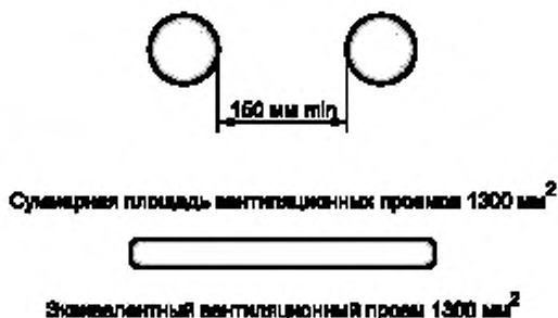
Рисунок 6 — Пример разных конструкций вентиляционных отверстий
