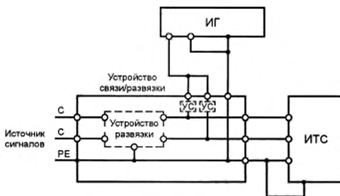
Рисунок 9б — Схема рабочего места с проводниками заземления (см. 7.1.2)
