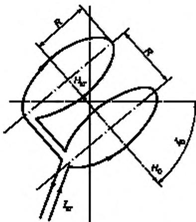
Рисунок Б.1 — Схема катушки Гельмгольца
