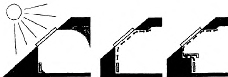
Рисунок А.4 — Примеры расположения мансардного оконного блока относительно откосов стен и отопительных приборов
