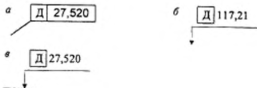
а — конструкции на плане; б — грунтовой или другой поверхности рельефа на плане, в — любой поверхности на разрезе
