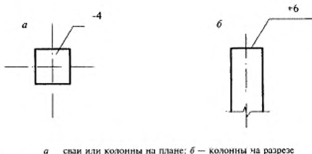
Рисунок 2 — Примеры указания действительных отклонений поверхностей
