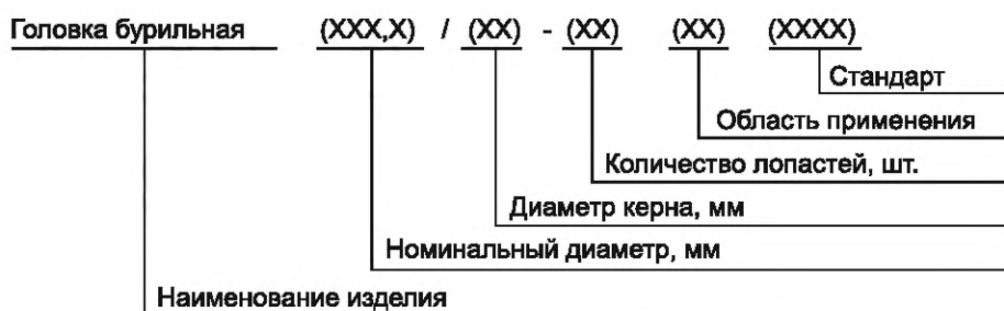
Рисунок 2 — Структура условного обозначения бурильных головок
