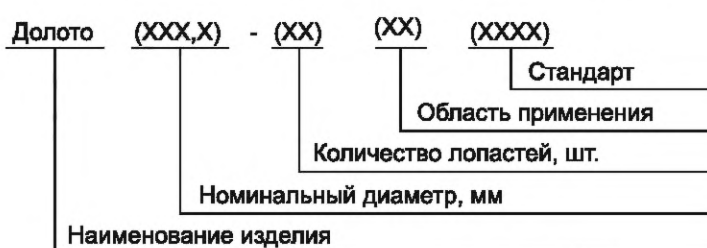
Рисунок 1 — Структура условного обозначения долот
