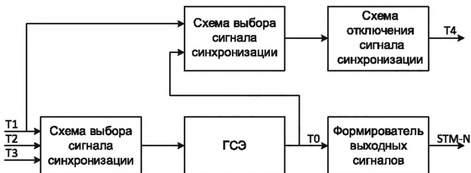
Рисунок 1 — Схема распределения сигнала синхронизации в мультиплексоре СЦИ
