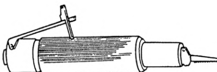
Рисунок В.4 — Напильник возвратно-поступательного движения
