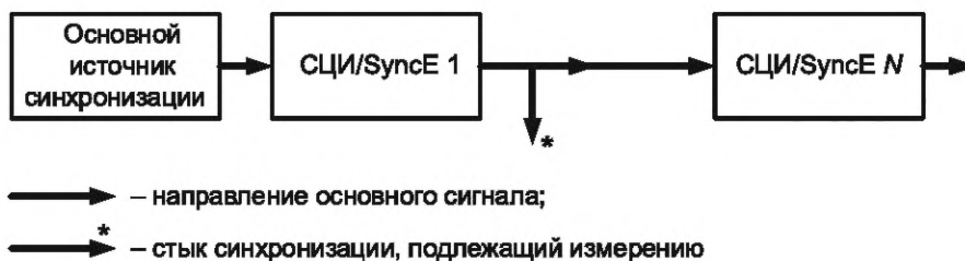
Рисунок 1 — Схема измерений параметров синхронизации по пункту 1 таблицы 1
