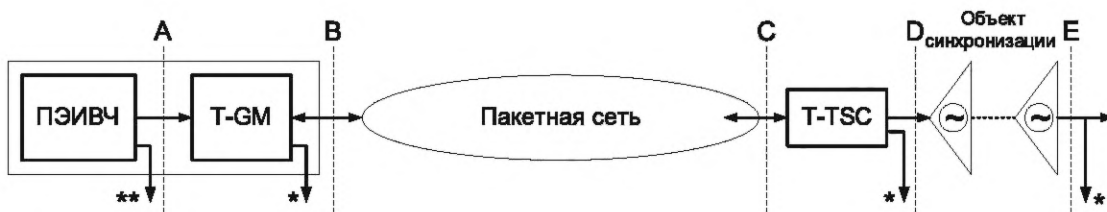
Рисунок 12 — Стыки синхронизации сети СШВ, подлежащие измерению, когда T-TSC встроен в объект синхронизации
