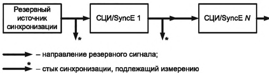
Рисунок 4 — Схема измерений параметров синхронизации по пункту 4 таблицы 1
