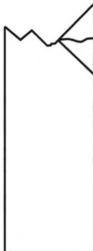
Рисунок В.11 — Разрушение при сжатии типа MGM: многотиповое разрушение через центр отверстия
