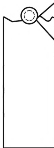
Рисунок В.15 — Разрушение при сжатии типа MGF: многотиповое разрушение крепления, гайки, шайбы
