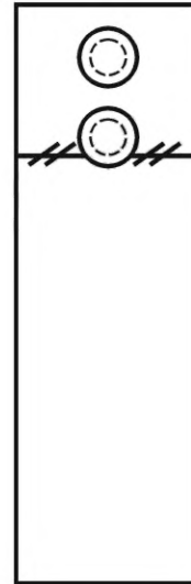
Рисунок В.14 — Разрушение при сжатии типа LGF: поперечное разрушение по краю крепления, гайки, шайбы (как правило происходит вдоль направления армирования 0°)
