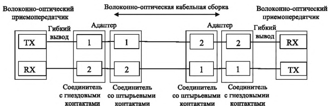
Рисунок 7.16 — Волоконно-оптическая летная кабельная сборка В-типа с одной линией
