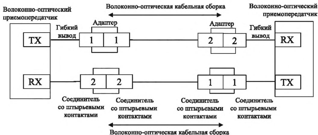
Рисунок 7.15 — Линия SpaceFibre в составе двух волоконно-оптических кабельных сборок А-типа, по одной сборке на направление
