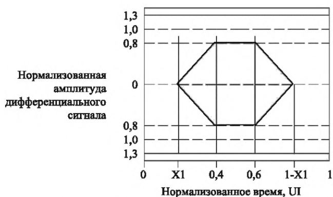
Рисунок 7.13 — Электрооптическая маска глазковой диаграммы передатчиков, предназначенных для работы в диапазоне битовых скоростей от 1 до 5 Гбит/с
