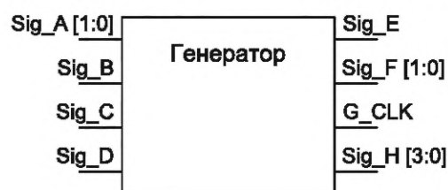
Рисунок 1 — Пример выполнения упрощенной схемы СФ-блока
