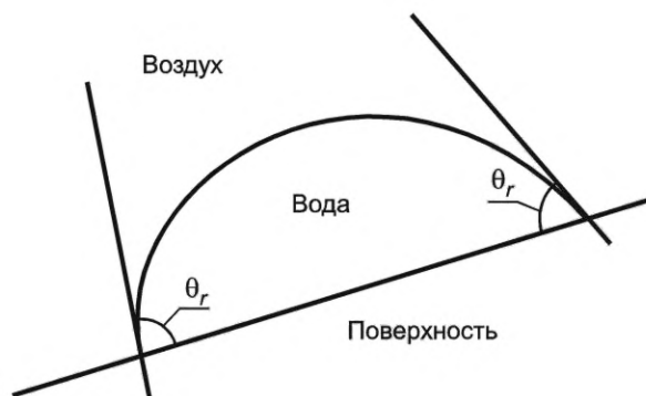
Рисунок Б.3 — Определение угла оттекания ( \theta_r ) на наклонной плоскости в момент начала движения капли
