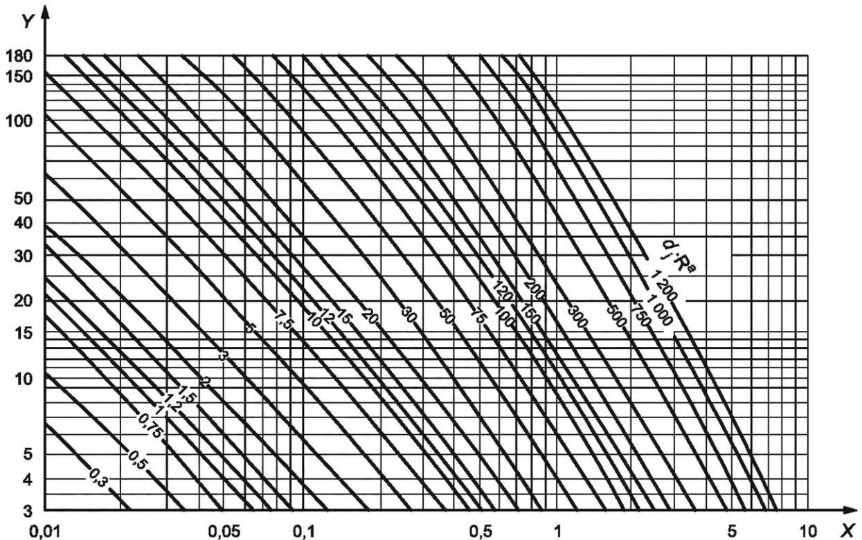
$X$  —  $\bar{C}_L$ , параметр нижнего предела взрываемости факельного газа, см. формулу (D.7);  $Y$  —  $x_c$ , расстояние по горизонтали от факельного ствола до центра пламени, м
