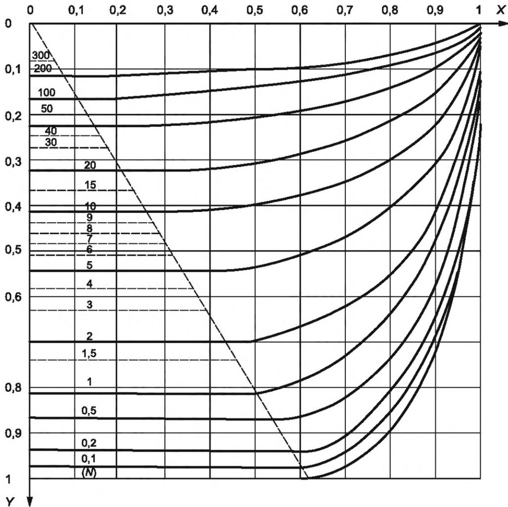
$X$  —  $p_3/p_1$  ( $p_2/p_1$  применять только для участков выше диагональной пунктирной линии); где  $p_3$  — давление в емкости, в которую производится сброс из трубопровода (101 кПа — при выбросе в атмосферу), кПа;  $p_1$  — давление у источника с низкой пропускной способностью выше по технологической схеме, кПа;  $p_2$  — давление в трубопроводе на выходе или в любой точке на расстоянии  $L$  ниже по технологической схеме от источника, кПа;
