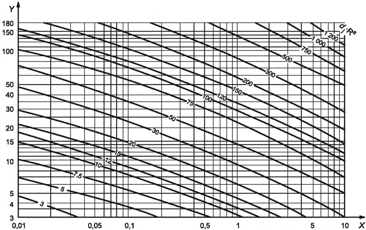
$X$  —  $\bar{C}_L$ , параметр нижнего предела взрываемости факельного газа, см. формулу (D.7);  $Y$  —  $y_c$ , расстояние по вертикали от факельного ствола до центра пламени, м;
