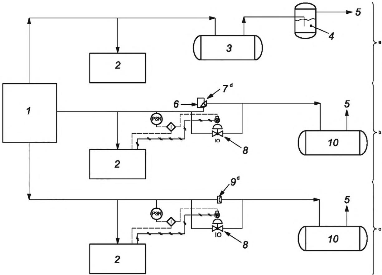
1 — от факельных сепараторов технологических модулей; 2 — утилизация факельного газа; 3 — факельный сепаратор; 4 — гидравлический затвор; 5 — на факел; 6 — продувка топливным газом; 7 — управляемый клапан сброса давления; 8 — клапан, открывающийся в случае превышения давления или при останове/разгрузке компрессора; 9 — МПУ или иное устройство сброса давления без функции повторного закрытия
