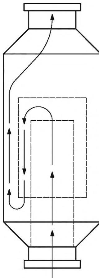
Рисунок 6 — Затвор для снижения потока газа для продувки.
