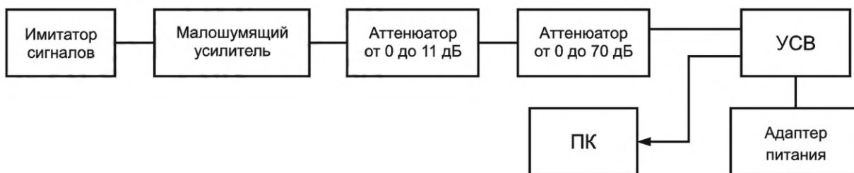
Рисунок В.3 — Схема определения чувствительности модуля ГНСС
