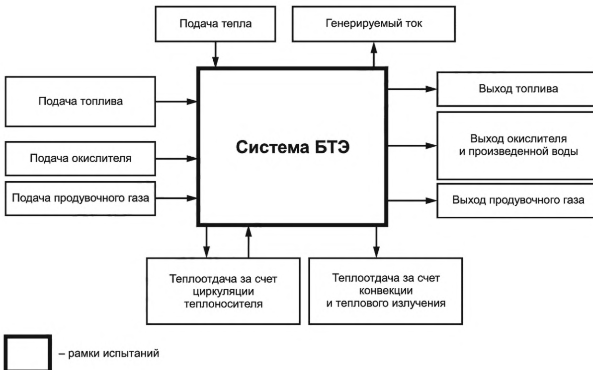
Рисунок 2 — Рамки испытаний системы БТЭ с ПОМ
