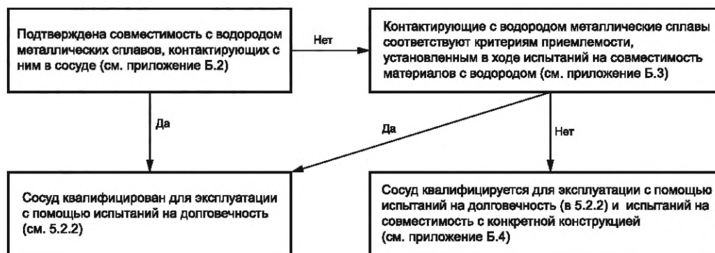
Рисунок В.1 — Процесс квалификации на совместимость с водородом
