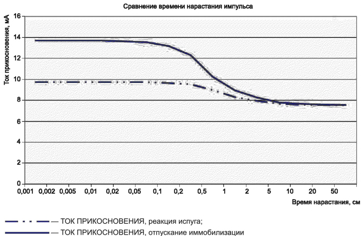
Рисунок Н.5 — График зависимости ТОКА ПРИКОСНОВЕНИЯ от времени нарастания для сигнала длительностью 20 мс прямоугольной формы
