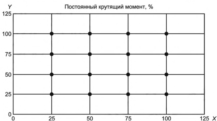
Рисунок 2 — Точки измерения, основанные на нормированном крутящем моменте
