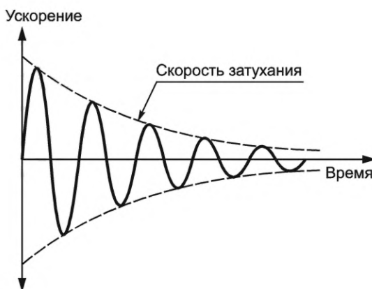
Рисунок 2 — Затухающий синусоидальный импульс
