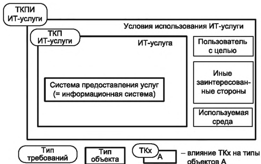
Рисунок М.1 — Объем требований, связанных с ИТ-услугами, и их связь с информационной системой
