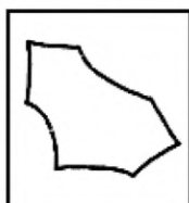
а) Угловатая форма ( l_{\max}/l_{\min} св. 2,0 до 5,0 включ.) с наличием криволинейных поверхностей
