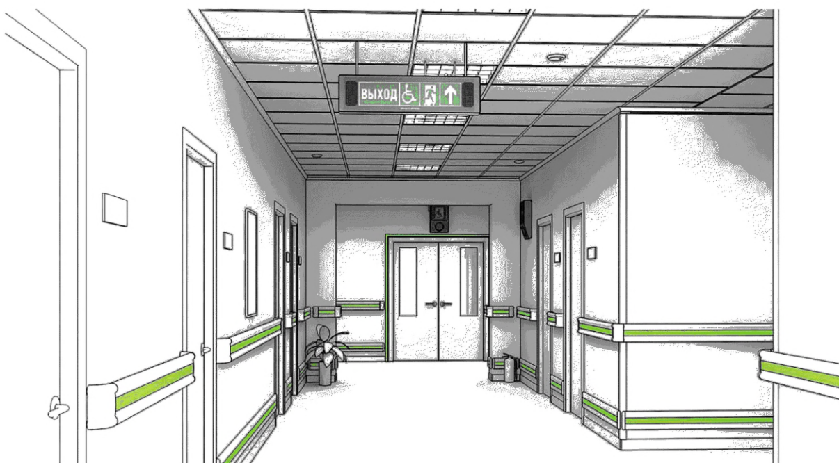
Рисунок А.6 — Пример размещения в коридоре двухстороннего информационного (визуально-акустического) табло для обозначения направления движения к эвакуационному выходу
