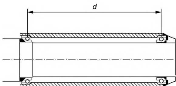
б) Измерение с интегрированными подшипниками d — поворотная опора для нагружения
