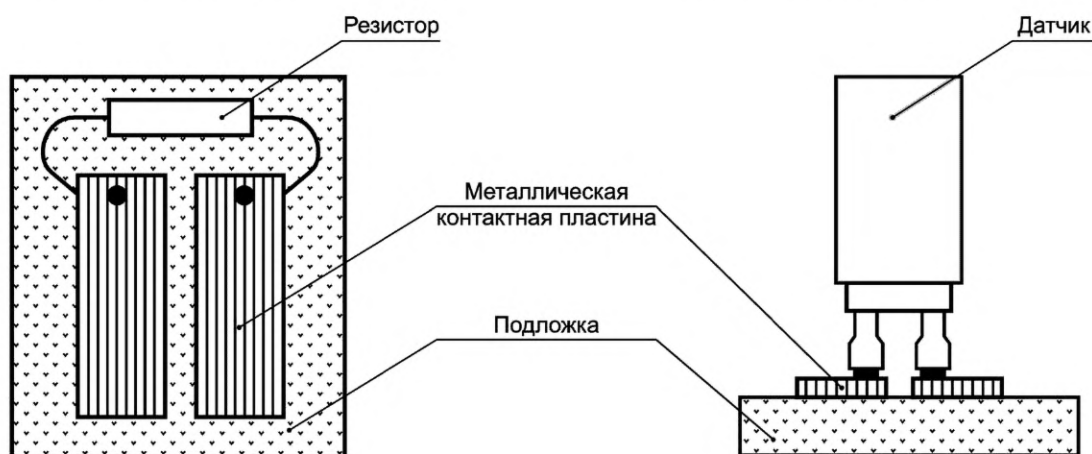
Рисунок А.3 — Устройство для проверки измерителя сопротивления
