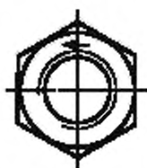
Рисунок 5 — Маркировка левой резьбы
