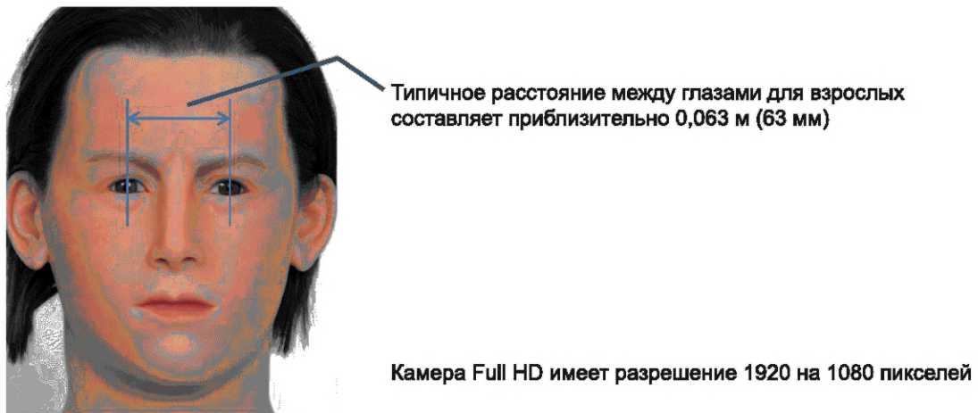
Рисунок 4 — Расстояние между глазами для расчета максимальной ширины области формирования изображения
