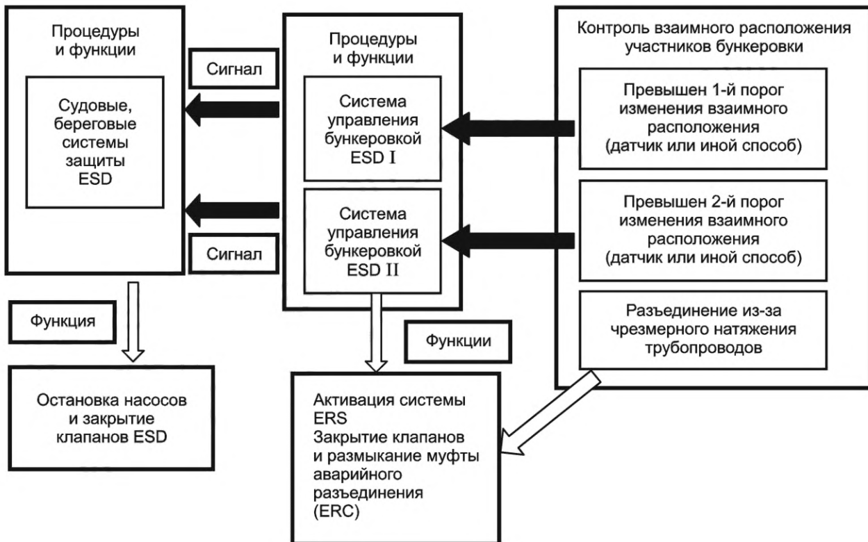
Рисунок Б.2 — Пример функциональной схемы с системами ESD I и с ESD II
