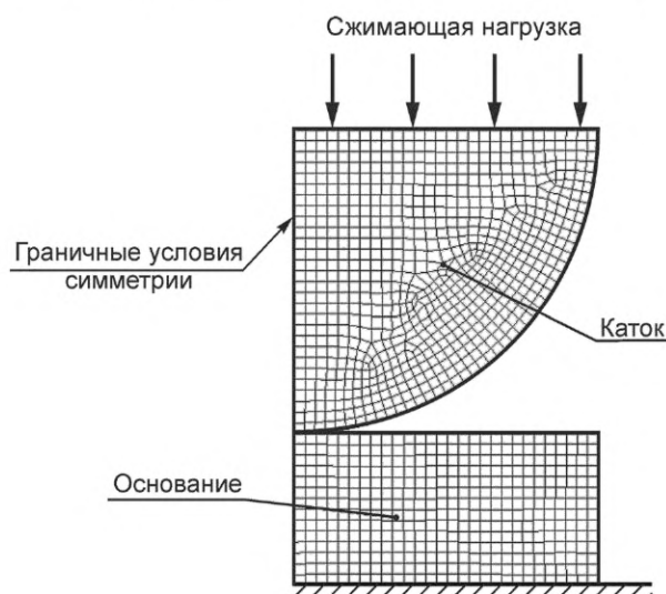
Рисунок Б.1 — Пример расчетной схемы катковой опоры
