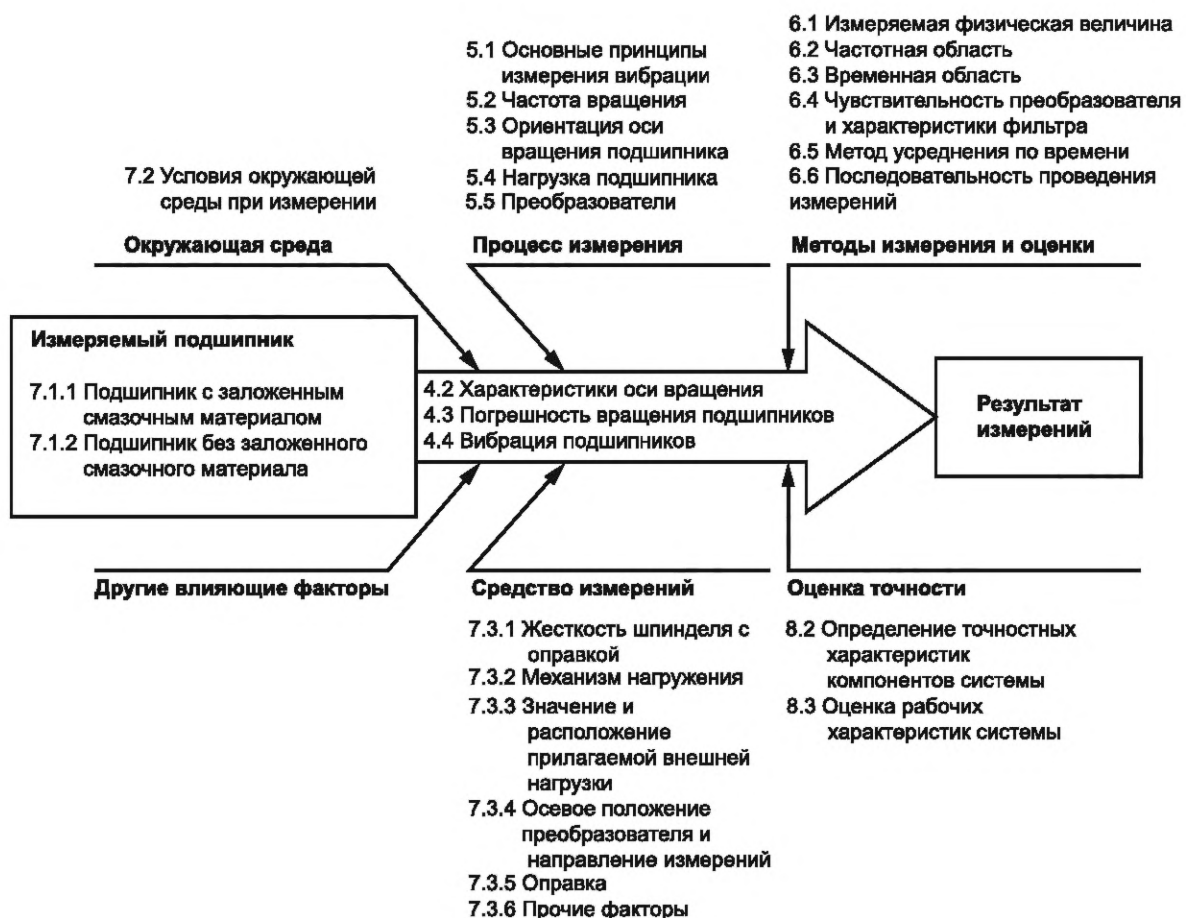
Рисунок 3 — Основные составляющие измерения вибрации подшипника
