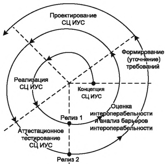
Рисунок 5 — Спиральный (эволюционный) жизненный цикл разработки СЦ ИУС
