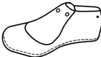
Рисунок А.2 — Колодка с плоским следом
