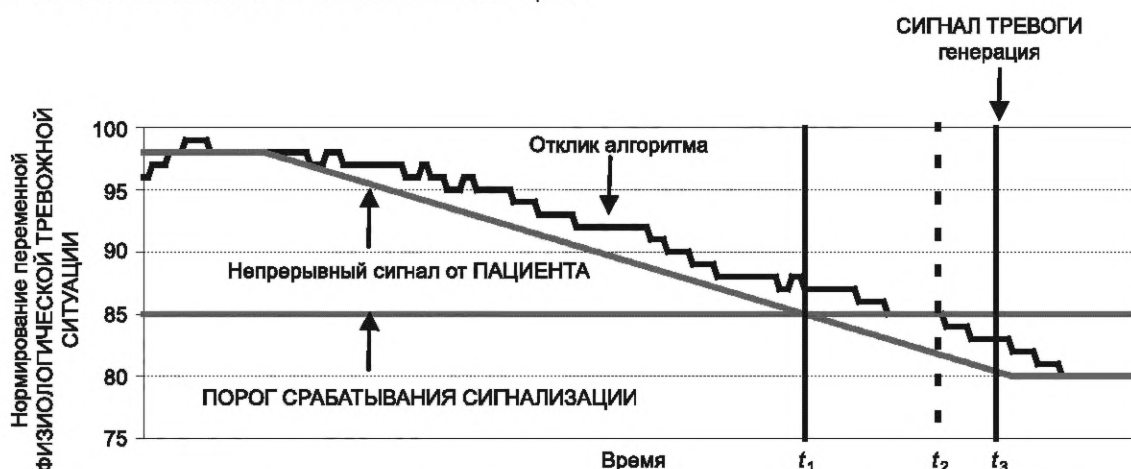
Рисунок А.1 — Графическое изображение элементов задержки СИСТЕМЫ СИГНАЛИЗАЦИИ
