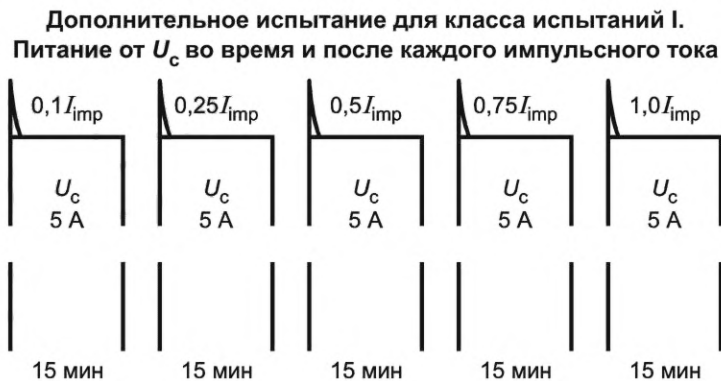
Рисунок А.3 — Схема временных характеристик испытания для дополнительных пяти импульсов
